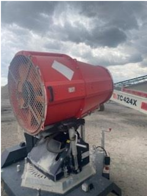
5. Wassersprühkanone mit 100 Meter Reichweite zur Staubbindung
