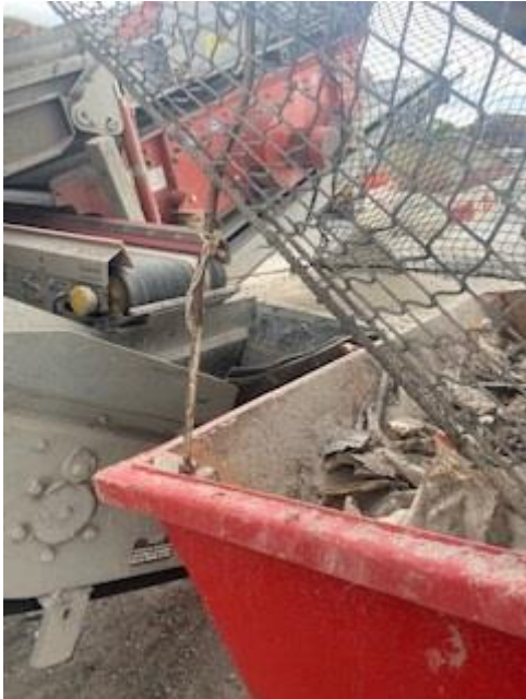
3. Absiebung mit 40 mm Maschenweite an integrierter Siebeinheit (Brecher mit Windsichter)
