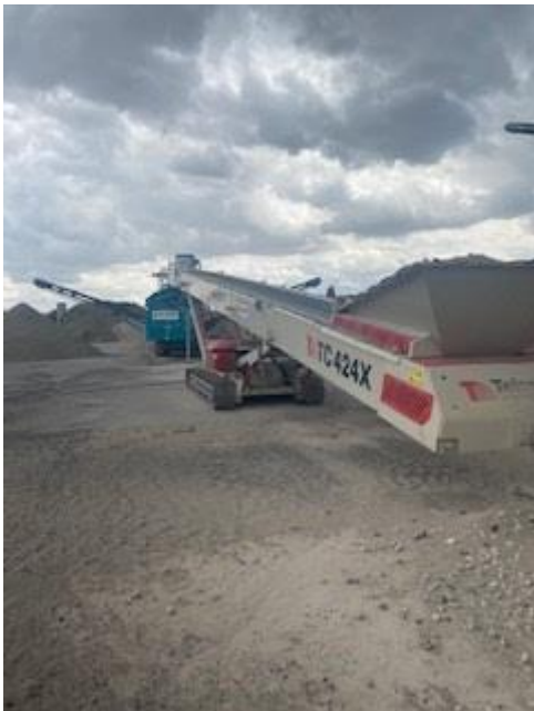
6. Übergabe RC-Material 0/32 mm mit Haldenband auf Siebmaschine „Chieftain 2200“
